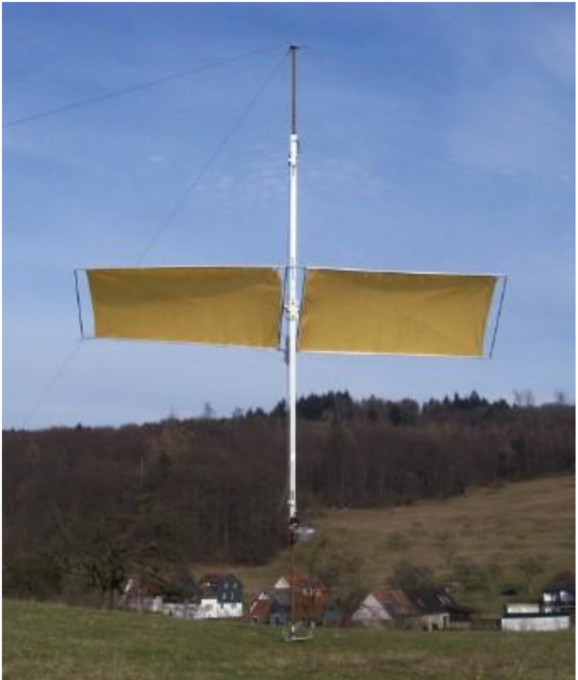
Abbildung 20: Windkraftwerk mit Segel am Mast (Prototyp) [15]
