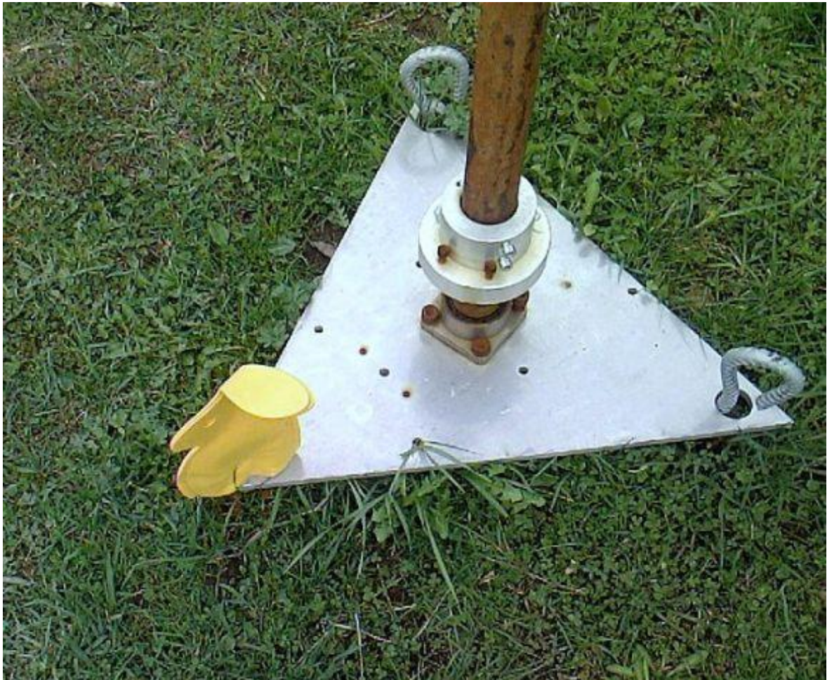
Abbildung 17: Bodenplatte mit Heringen und Drehgelenk [15]
