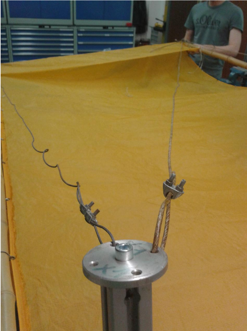
Abbildung 40: Segel im nicht verspannten Zustand
